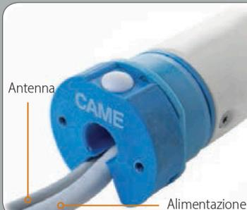
Motore 230 V AC - 50 Hz a comando via radio con ricevitore 433.92 MHz integrato. Finecorsa elettronico. Protezione del motore in caso di blocco dell'azione di avvolgimento dovuto ad ostacolo o altro impedimento meccanico. Possibilità di regolazione del punto di finecorsa intermedio (apertura parziale). L'antenna deve rimanere all'esterno.
