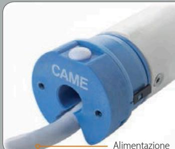
Motore a comando filare 230 V AC - 50 Hz. Finecorsa elettronico via cavo. Protezione del motore in caso di blocco dell'azione di avvolgimento dovuto ad ostacolo o altro impedimento meccanico. Regolazione facile del finecorsa tramite pulsante sulla testa (esclusa Moovicaincasso) o con accessorio per la programmazione (optional).
