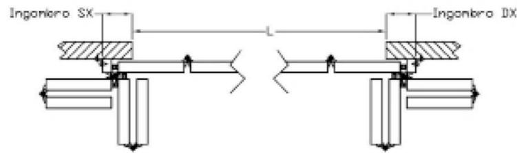
I montanti sono posizionati oltre luce e le ante sono raccolte in luce (apertura 90°) oltre luce (apertura 180°) Formula per rilevare la misura definitiva da fatturare:  $[L \text{ (larghezza foro)} + (\text{ingombro Sx+DX})] \times H \text{ (Altezza foro)}$
